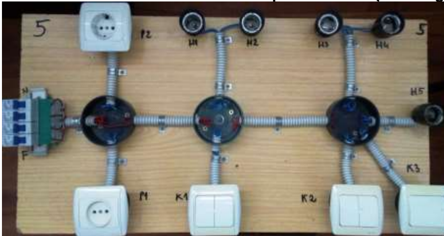
Figura 4.4 Panoplie demonstrativă cu instalație de iluminat și prize
